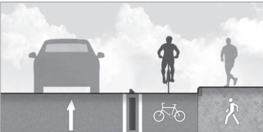
Рисунок 5.16. Тип поперечного профілю вулиці з влаштуванням конструктивного відокремлення велосипедної смуги
